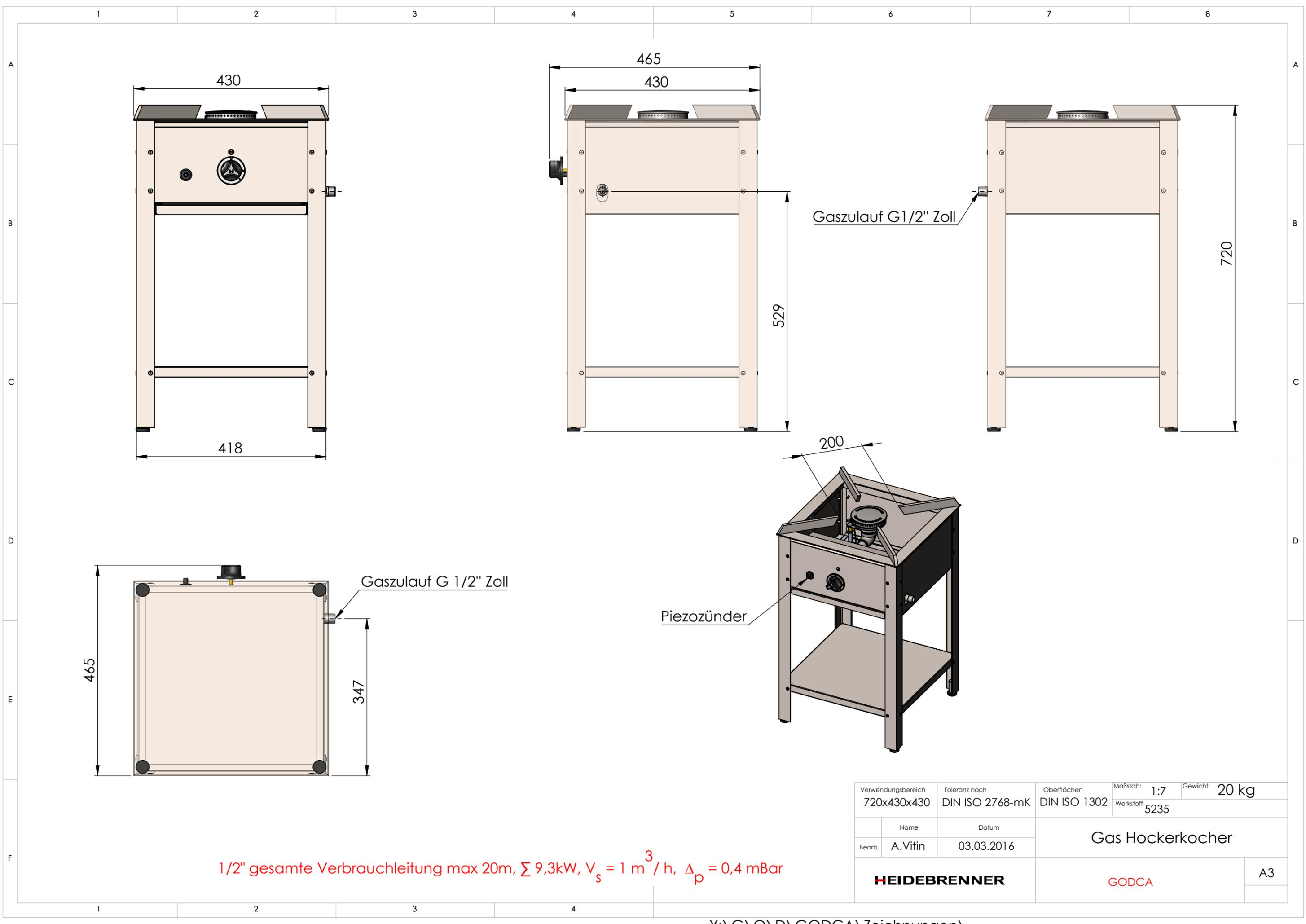
1/2" gesamte Verbrauchleitung max 20m,  $\Sigma 9,3\text{kW}$ ,  $V_s = 1 \text{ m}^3 / \text{h}$ ,  $\Delta p = 0,4 \text{ mBar}$
