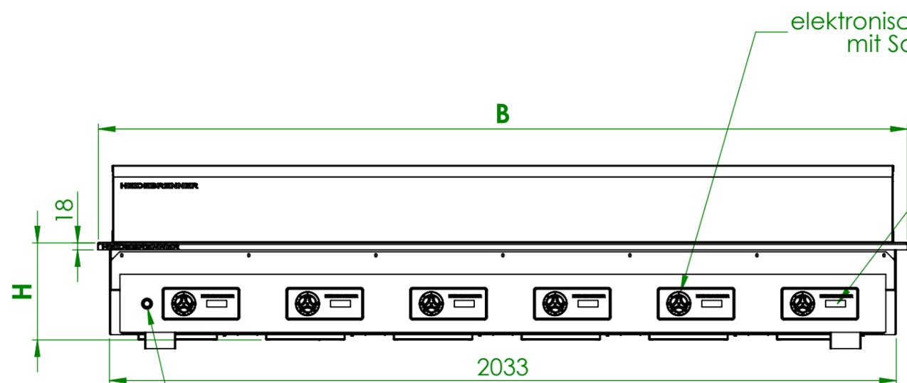
elektronischer Microstat T=50...290°C mit Soll Temperaturanzeige
